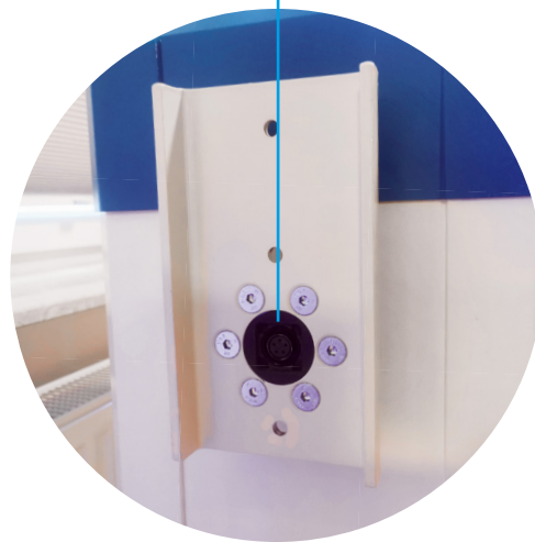
Multi-Kontaktstecker in der Baumaufnahme
